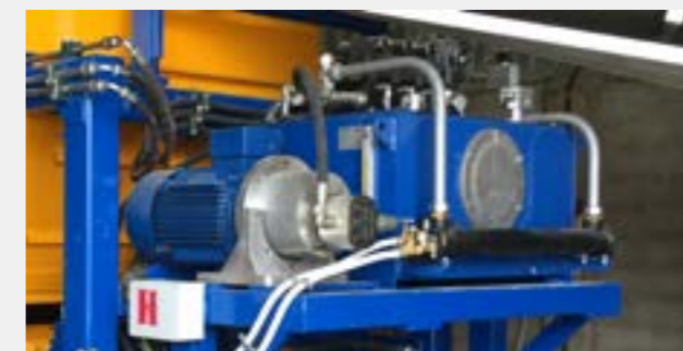
Equipo hidráulico con refrigeración
