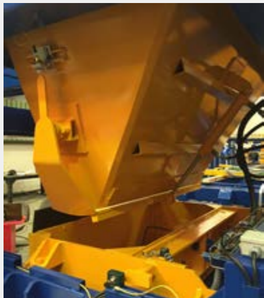
Cajón alimentador y tolva hidráulica
